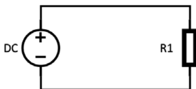
Figura 1.1 Montaje de circuito básico para ley de ohm
