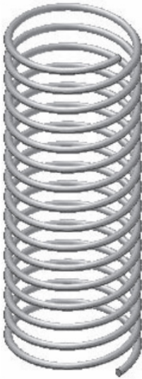
Figura P3-6: figura construida en MMGS se debe elegir por parte del diseñador el plano de trabajo que más información proporcione para la construcción de la pieza. Dibuja la siguiente primavera. Diámetro =2.00 Diámetro del alambre = 0.125 Paso= 0.375
