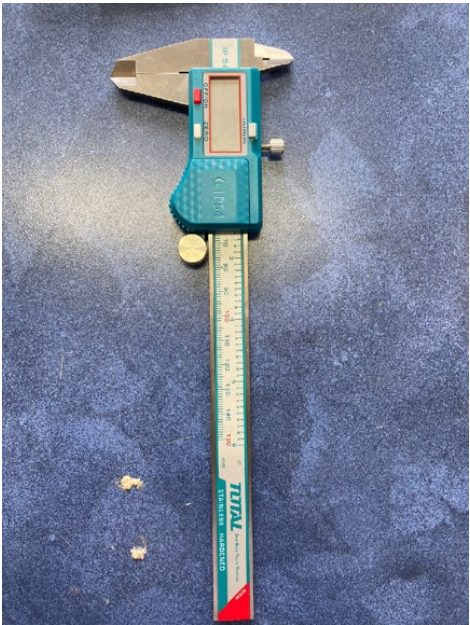
Figura 8. Pie de rey digital y análogo Fuente. Elaboración propia
