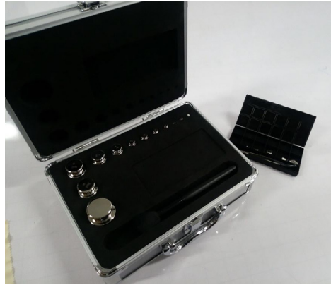
Figura 2. Juego de pesos patrones del laboratorio de calidad de la Unicomfauca marca Trumax
