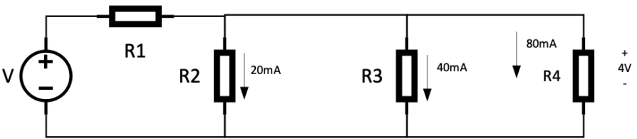
Figura 3.5 Divisor de corriente
